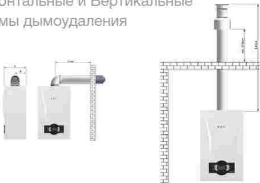
Горизонтальный коаксиальный дымоход Максимальная длина L, макс.: 10 м, ØD/100 Максимальная длина L, макс.: 20 м, ØD/125
