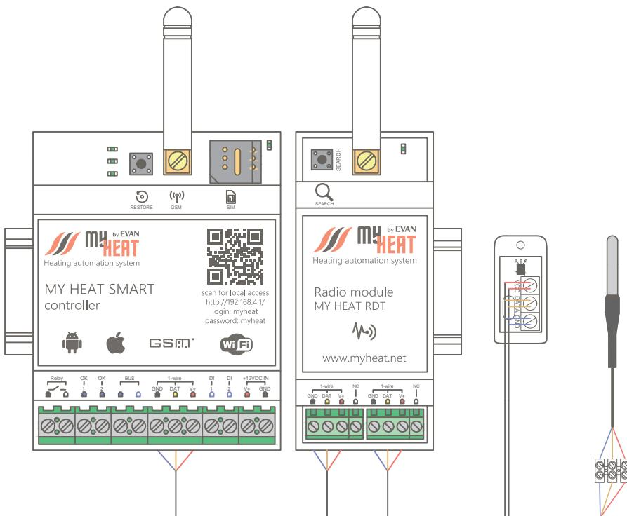
1. Модуль монтируется на DIN-рейку. Для надежной фиксации модуля на DIN-рейке необходимо аккуратно надавить на него до щелчка, чтобы крепежные защелки зафиксировали модуль на рейке.
